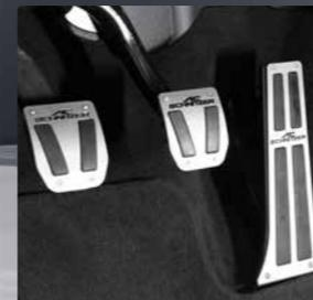
Pedalauflagen für GR Supra mit Sechsgang-Schaltgetriebe
