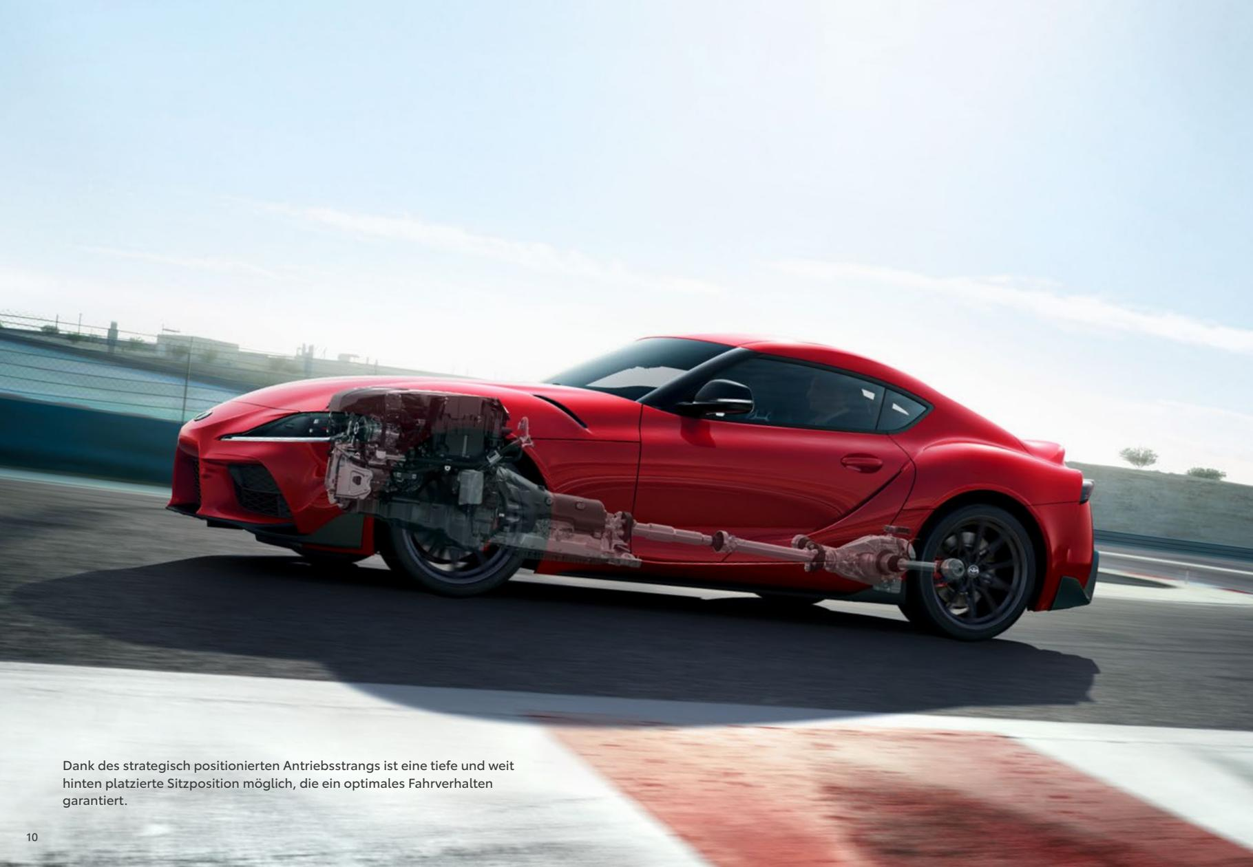
Dank des strategisch positionierten Antriebsstrangs ist eine tiefe und weit hinten platzierte Sitzposition möglich, die ein optimales Fahrverhalten garantiert.
