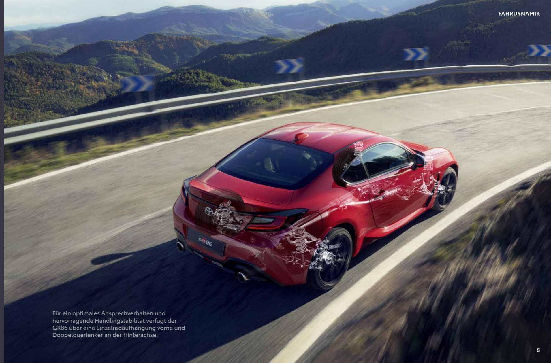
Für ein optimales Ansprechverhalten und hervorragende Handlingstabilität verfügt der GR86 über eine Einzelradaufhängung vorne und Doppelquerlenker an der Hinterachse.
