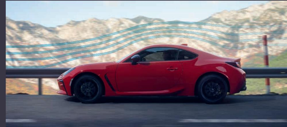
Der GR86 verfügt über eine herausragende Aerodynamik. Dafür sorgen unter anderem die vorderen Luftauslässe, seitliche Spoiler in Schlitzform und ein nach oben geschwungener Heckspoiler – entwickelt auf Basis der langjährigen Toyota Rennsporterfahrung.
