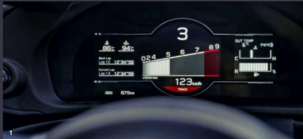
1. Im TRACK-Modus wechseln die Anzeigen in ein vom Rennsport inspiriertes Design mit Rundenzeit, Drehzahl, Öltemperatur und anderen Fahrinformationen.
