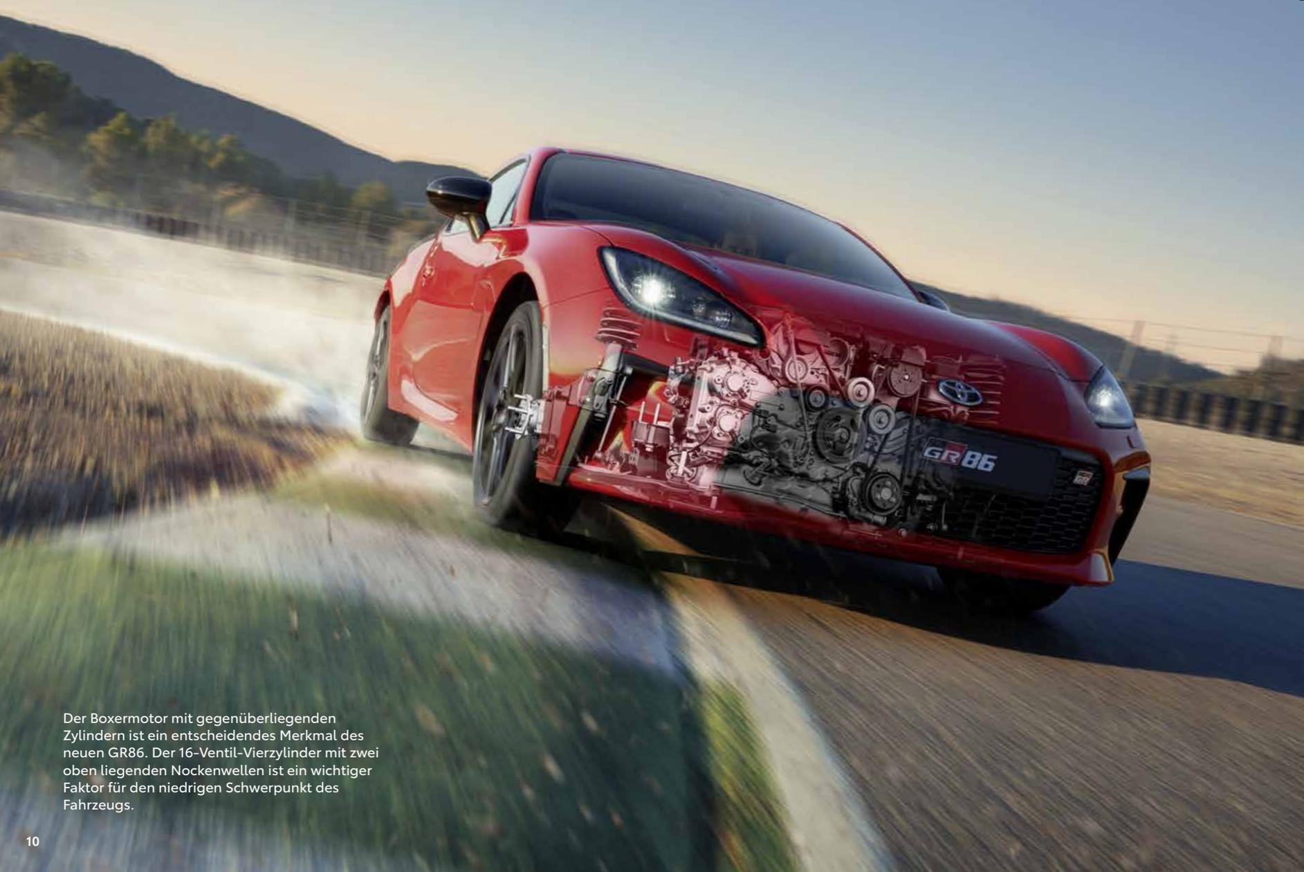
Der Boxermotor mit gegenüberliegenden Zylindern ist ein entscheidendes Merkmal des neuen GR86. Der 16-Ventil-Vierzylinder mit zwei oben liegenden Nockenwellen ist ein wichtiger Faktor für den niedrigen Schwerpunkt des Fahrzeugs.
