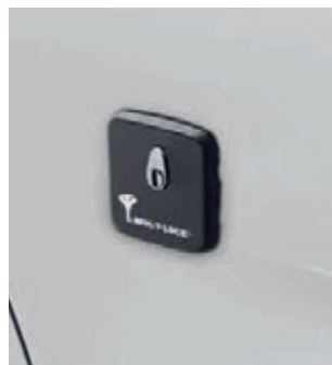
SICHERHEITS-TÜRSCHLOSS Mit dem Sicherheitsschloss kann die Sicherheit des Proace City deutlich erhöht werden, insbesondere wenn sich darin wertvolle Ware oder Ausrüstung befindet.
