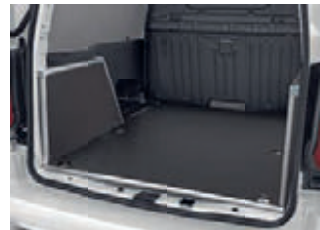
BODEN MIT WANDVERKLEIDUNG IN ZWEI AUSFÜHRUNGEN 1. Holzverbundplatte, lackiert 2. Kunststoff, Polypropylen
