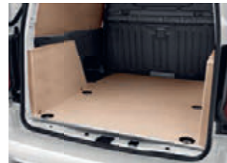
BODEN MIT WANDVERKLEIDUNG IN ZWEI AUSFÜHRUNGEN 1. Holzverbundplatte, lackiert 2. Kunststoff, Polypropylen
