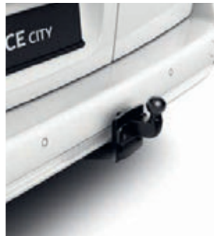
ANHÄNGEZUG-VORRICHTUNG Zur geflanschten Anhängenzugvorrichtung wird auch ein 13-poliger Elektrosatz angeboten.
