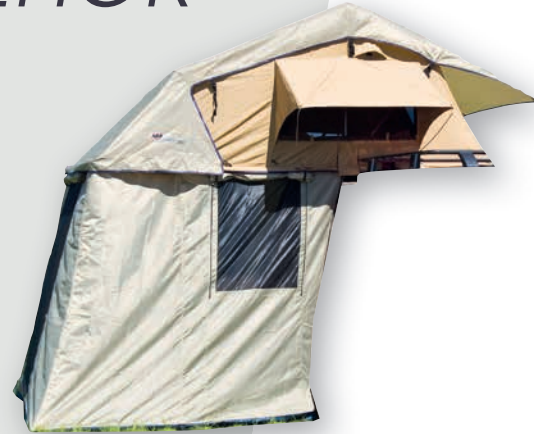
ARB-Dachzelt Simpson III, inkl. Anbau Liegefläche von 2,40 m x 1,40 m und mit einer Höhe von 1,30 m, Matratze und Bettwäsche verbleiben während der Fahrt im Zelt
