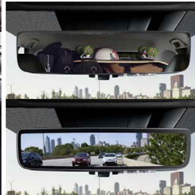
Mal wieder zu viel eingepackt und jetzt keinen Durchblick mehr? Ein klarer Fall für den Smart-View-Mirror. Das ist der automatisch abblendende Innenspiegel, der sich auf Knopfdruck in einen hochauflösenden Monitor verwandelt und dann Bilder einer in die Heckscheibe integrierten Kamera anzeigt.
