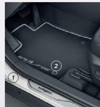
Einstiegsleisten aus Aluminium (1) (vorne und hinten) mit Fußmatten aus Velours oder Gummi (2)
