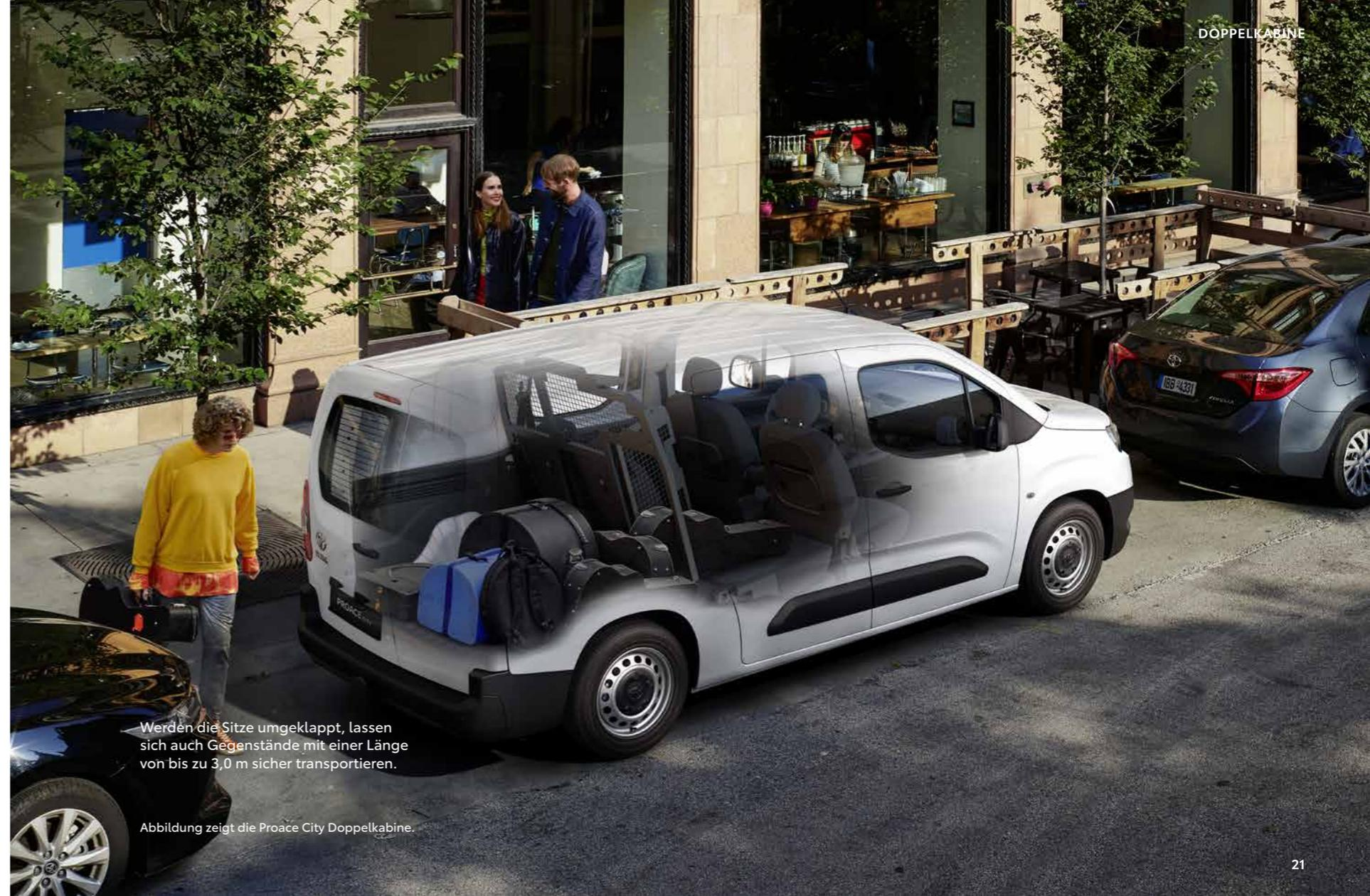
Werden die Sitze umgeklappt, lassen sich auch Gegenstände mit einer Länge von bis zu 3,0 m sicher transportieren.
