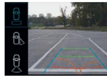
Fahrer erweiterte Sicht in den toten Winkel der Beifahrerseite und erhöht die Sicherheit insbesondere im Stadtverkehr. Bei eingelegetem Rückwärtsgang wechselt die Kamera in einen Nahsichtmodus und gibt so optimale Unterstützung beim Parken und Rangieren.
