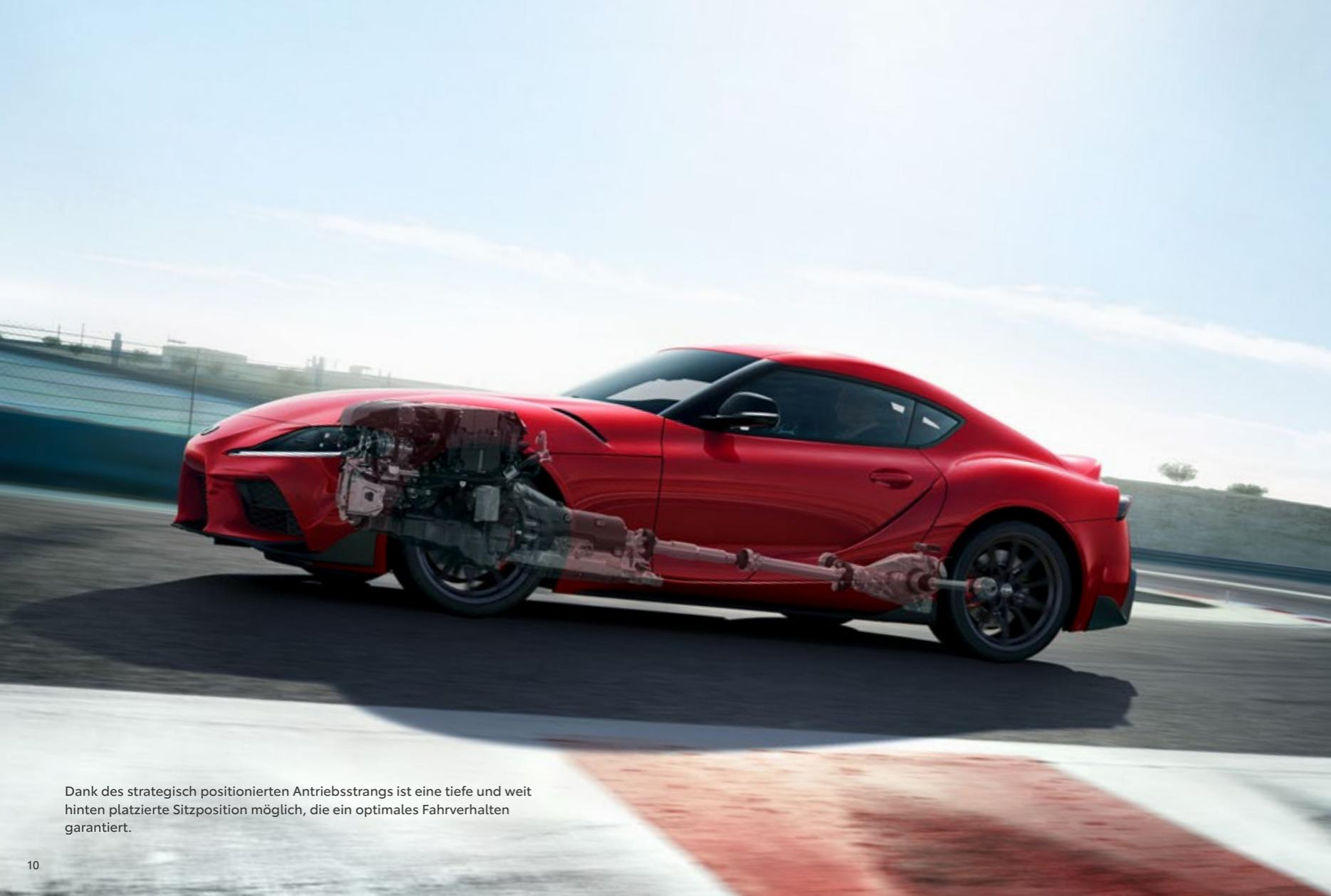
Dank des strategisch positionierten Antriebsstrangs ist eine tiefe und weit hinten platzierte Sitzposition möglich, die ein optimales Fahrverhalten garantiert.
