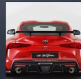
Schalldämpfer zweiflutig mit Sport-Carbon-Endblenden, Durchmesser: 100 mm
