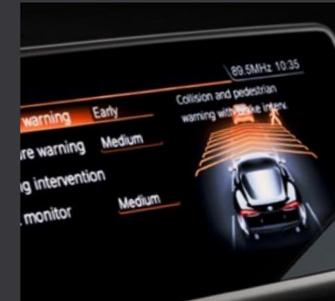
**PRE-COLLISION SYSTEM MIT FUSSGÄNGER-/RADFAHRERERKENNUNG**
