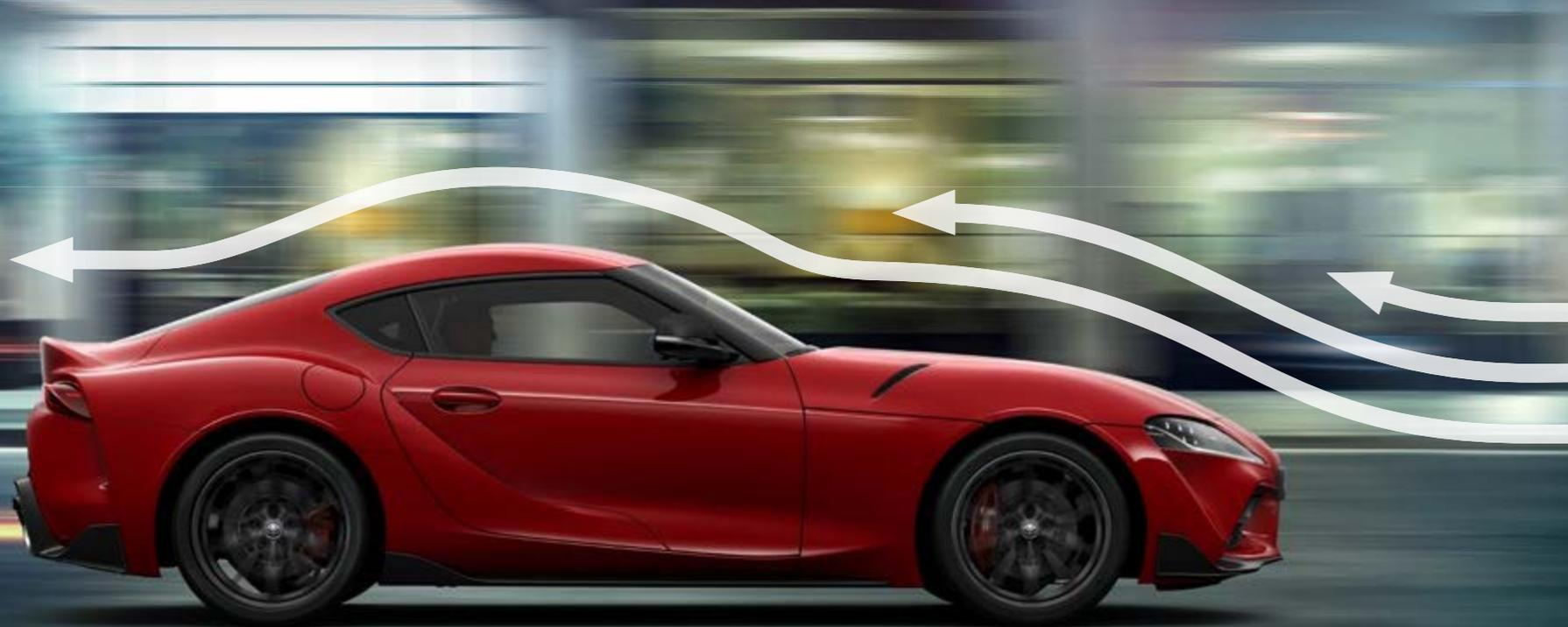
Die hochsteife Karosserie ermöglicht exzellente Aerodynamik und Stabilität für erstklassiges Fahrverhalten. Zusätzlich reduziert das Double-Bubble-Dach den Luftwiderstand und der gewölbte Heckspoiler senkt den Auftrieb.
