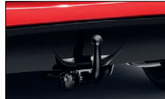
Anhängезugvorrichtung mit abnehmbarer Kupplungskugel, horizontale Verriegelung
