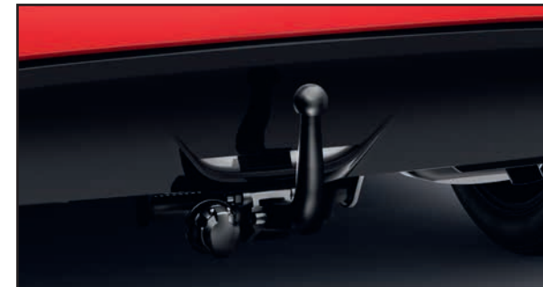
Anhängenzugvorrichtung mit abnehmbarer Kupplungskugel, horizontale Verriegelung
