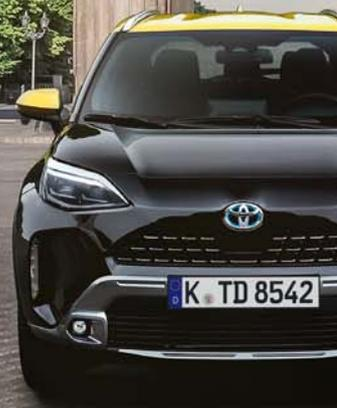
*Toyota Yaris Cross Hybrid 1,5-L-VVT-iE: Benzinmotor 68 kW (92 PS) und Elektromotor 59 kW (80 PS), Systemleistung 85 kW (116 PS), Kraftstoffverbrauch Kurzstrecke (niedrig) 4,7–3,9 l pro 100 km, Stadtrand (mittel) 4,8–4,0 l pro 100 km, Landstraße (hoch) 5,2–4,4 l pro 100 km, Autobahn (Höchstwert) 6,8–6,0 l pro 100 km, kombiniert 5,0–4,5 l pro 100 km, CO<sub>2</sub>-Emissionen kombiniert 112–102 g pro km (Werte gem. WLTP-Prüfzyklus)*
